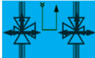
Fent nyitva Alul zárva Lehetséges folyásirány: balra/jobbra
